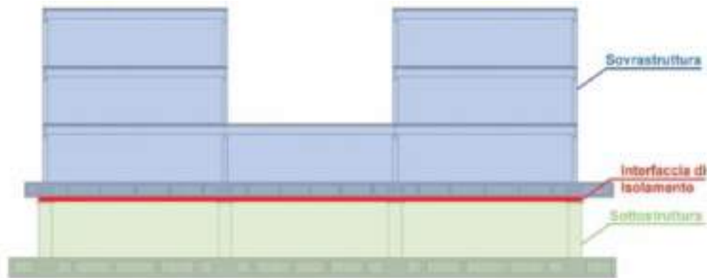
Schema di Sezione con indicazione della Sovrastuttura, dell'interfaccia di isolamento e della sottostruttura
